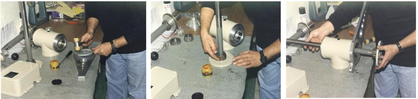
Per ciascun raccordo ho realizzato al tornio tre tappi filettati in alluminio e dopo averli avvitati definitivamente con serrafiletto ai raccordi, sempre al tornio sono state lavorate le facce di detti tappi per il parallelismo e le sedi per i cuscinetti a rulli conici dove sarebbero stati montati gli assi di A.R. e declinazione.
