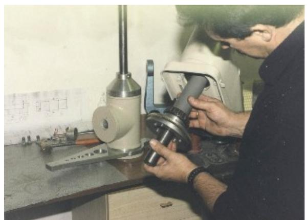
Nell'asse di A.R. del diametro di 60 mm è montata per movimento orario una corona dentata in bronzo con frizione. Il rapporto di riduzione è di 1:144.
