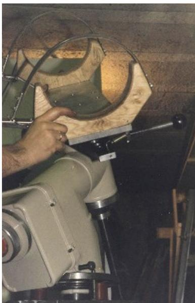
Per un rapido montaggio del tubo ottico alla montatura, la culla portastrumento è stata dotata di due bandelle flessibili fissate ad un'estremità e dotando la chiusura dall'altra parte con due grossi rapidi moschettoni. per equilibrare il carico quando è montato il tubo ottico, all'altra estremità dell'asse di declinazione sono montati dei contrappesi realizzati da 5 dischi in ghisa di 2 Kg ciascuno comunemente usati nel body-building.
