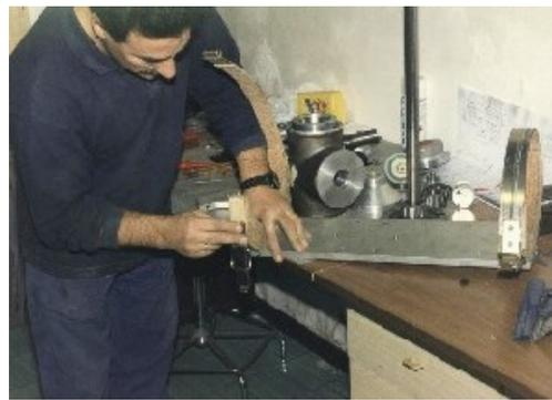
Un particolare curioso: il carter che doveva essere la copertura della meccanica posteriore, è stato ricavato dal contenitore di un vecchio contatore trifase in disuso, scelta, questa, non ricercata volutamente ma che in seguito si è rivelata un'ottima soluzione.
