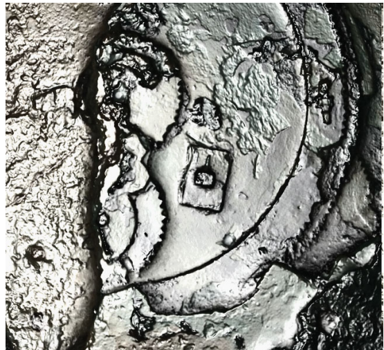
Figura 12 - Meccanismo pin & slot (fonte: Antikythera Project)
